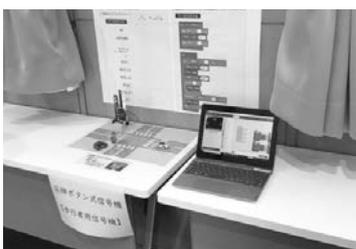
できる課題を設定し、解決していく活動を通して、主体的・対話的な深い学びの実現をねらいとした。その際、グループで協力し、既習事項をいかした。教材には、信号機の拡張モジュールを取り付けたマイコンボード（＝micro:bit）を用い、プログラミング言語は、プログラムをテキストで記述するのではなく、視覚的なオブジェクトでプログラミングするビジュアルプログラミング言語（＝Java Script ブロックエディタ）を用いた。計測・制御の基本的な仕組みを理解させるとともに、簡単なプログラム言語を用いてプログラムを制作した。
